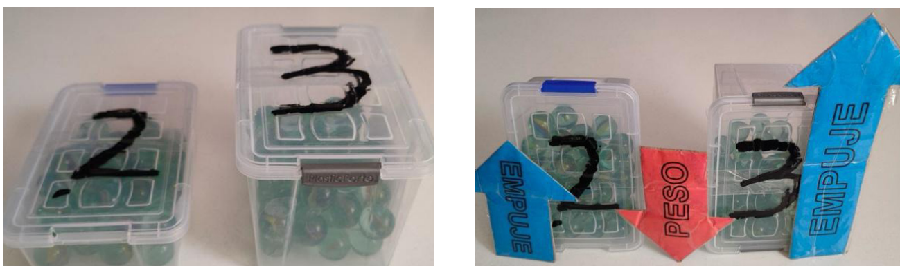
Fuente: Elaboración propia Figura 3. Cajas nº 2 y 3 utilizadas para que el alumnado comprenda el efecto de la fuerza de empuje del agua sobre los objetos que se introducen en ella.
